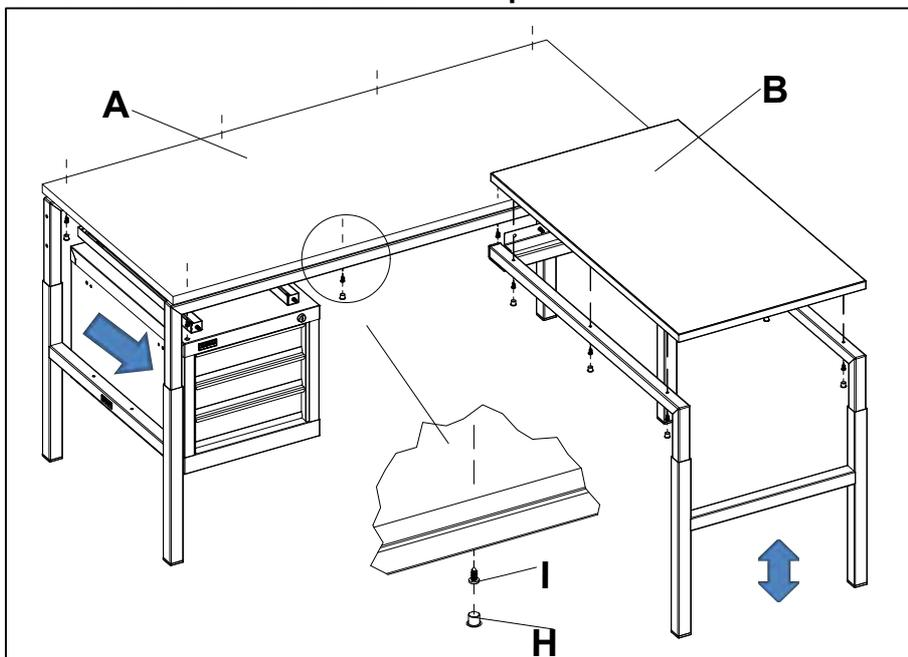
Установить столешницу **A** и столешницу дополнительную **B** (при наличии) с помощью саморезов **I** (5,5x16). Установить заглушки **H** в отверстия в раме. После монтажа столешниц выдвинуть вперёд тумбу инструментальную и установить её заподлицо с рамой. Протянуть весь крепёж.
