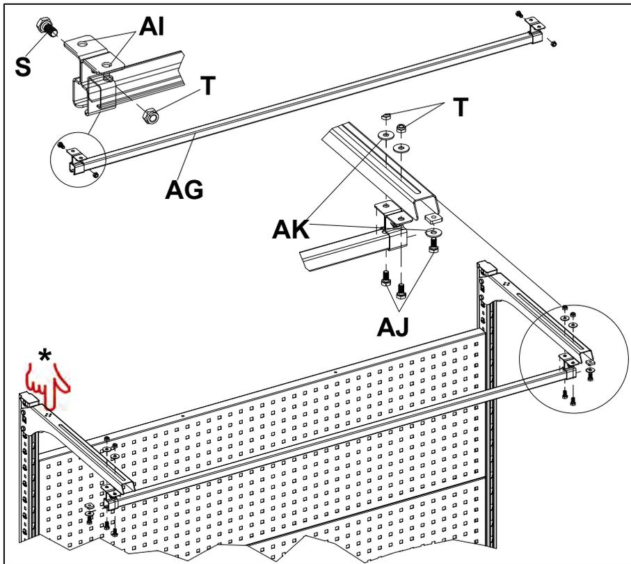
Установить кронштейны **AI** на перекладину-направляющую **AG** в двух местах при помощи болтов **S** (M8x50) и гаек **T**. Установить кронштейны вместе с перекладиной-направляющей на консоли при помощи болтов **AJ** (M8x16), гайки **T** и шайбы **AK**. Установить ограничители на перекладину-направляющую, наживив болты **AJ** (M8x16) и шайбы **AK** на пластины **AL**. На консоли предусмотрены отверстия под хомуты и заземление \*.
