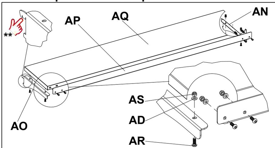
Установить кронштейны **AN**, **AO** и упор **AP** на полку **AQ** при помощи винтов **AR** (M6x16), шайбы **AD** и гаек **AS**. Установить полку на стойки экрана прямо или под углом 15° используя необходимые пазы на упорах \*\*.
