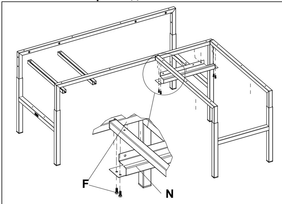
При наличии рамы дополнительной состыковать её с рамой основной при помощи кронштейна **N** и болтов **F** (M8x20). Болты наживить.
