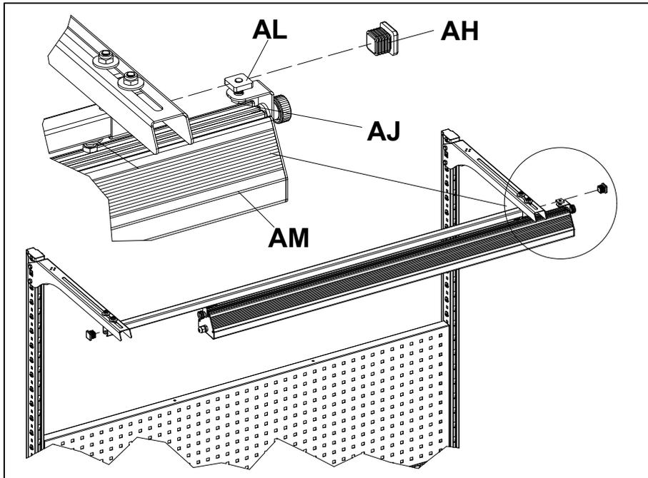
Наживить болты **AJ** (M8x16) и пластины **AL** на светильник **AM**. Завести светильник в перекладину-направляющую. Установить заглушки **AN** с обоих торцов перекладины-направляющей. Протянуть весь крепёж.
