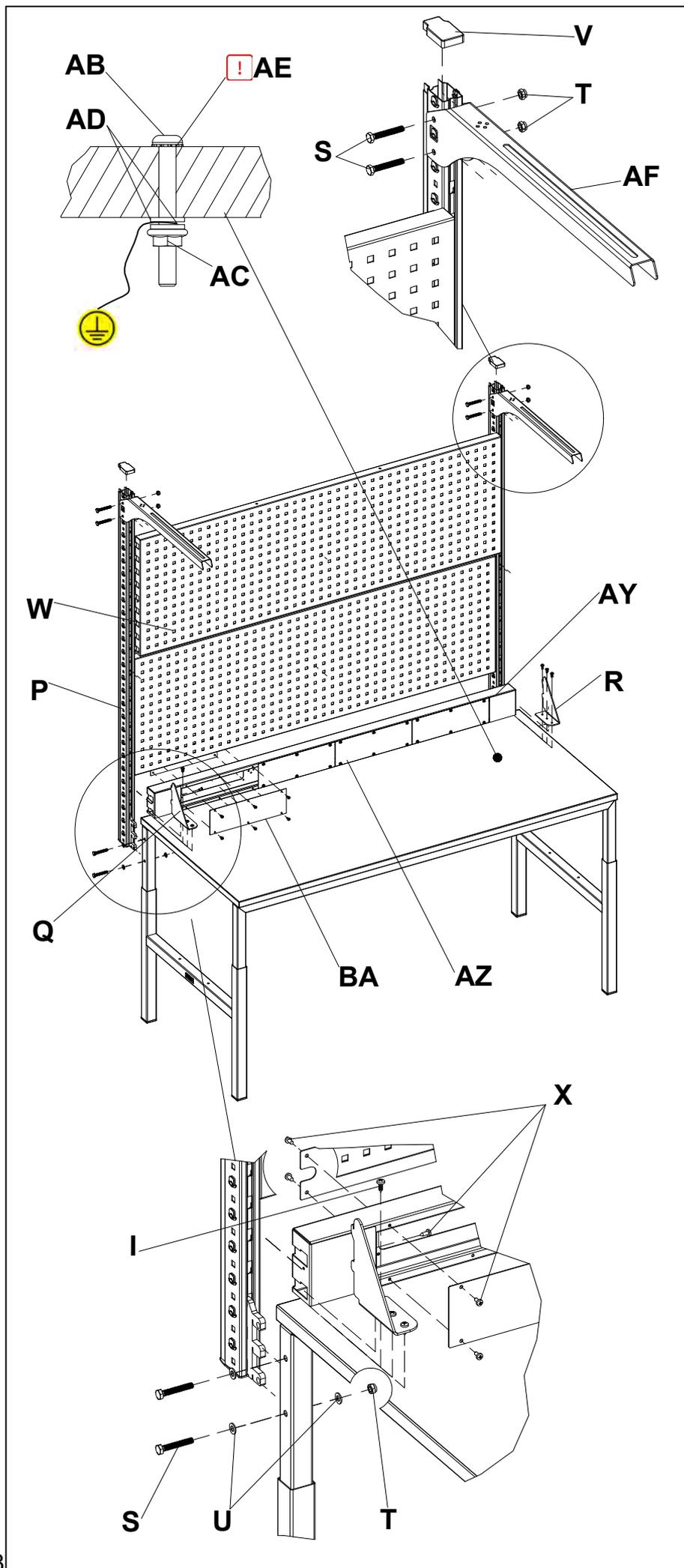
Установить заглушки **V** на стойки экрана **P**. Установить зацепы стоек экрана в отверстия на задней стороне рамы и зафиксировать с помощью болтов **S** (M8x50), шайб **U** и гаек **T**.
