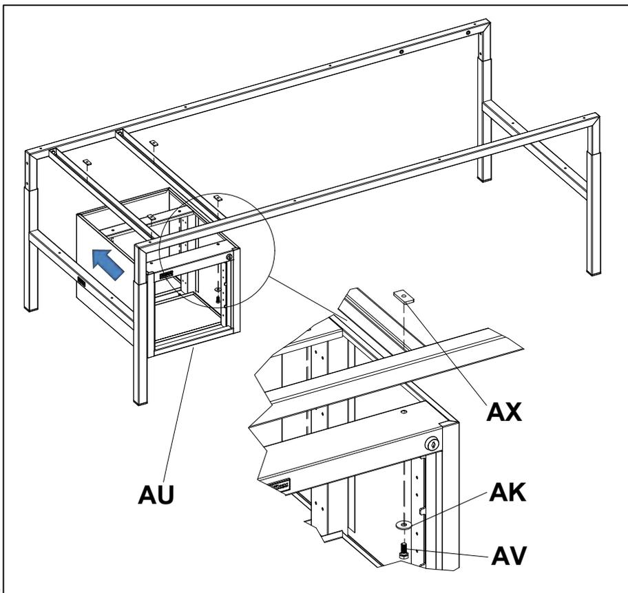
Наживить тумбу подвесную CP-M-003 **AU** на раму при помощи болтов **AV** (M8x18), шайб **AK** и гаек прямоугольных **AX**.
