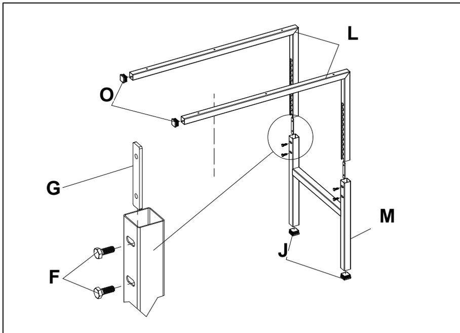
Установить заглушки **O** на рамы стола дополнительного **L** и заглушки **J** на раму продольную дополнительную **M**. Установить рамы стола дополнительного в раму продольную дополнительную на требуемой высоте, наживив гайки **G** на болты **F** (M8x20).
