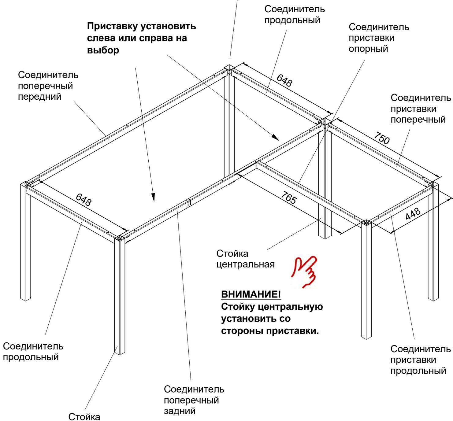
**3.2. Зафиксировать Раму при помощи угловых кронштейнов и болтов.**
