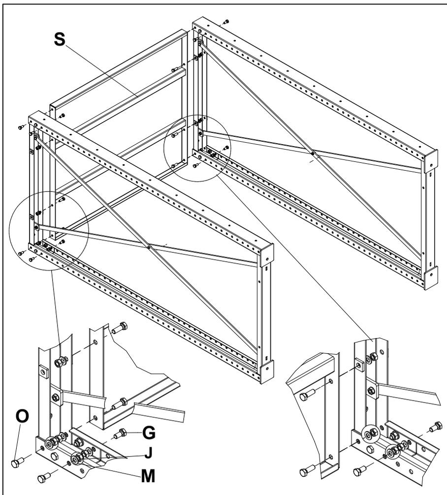
Наживить полку **S** на раму при помощи болтов **O** (M12x35), шайб **M** и гаек **J**.
