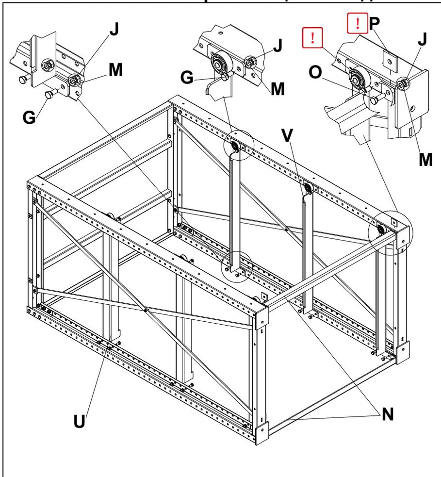
Наживить направляющие платформ неполного выдвижения **U, V** на рамы при помощи болтов **G** (M12x25), шайб **M** и гаек **J**, а также наживить соединители **N** при помощи болтов **O** (M12x35), шайб **K** и гаек **H** и пластин **P**.
