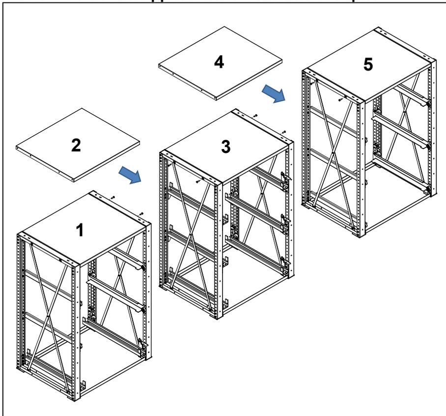
При установке секций в линию сначала собрать нечётные секции, затем установить полки между ними, после чего установить направляющие, соединители и системы антипрокидывания.
