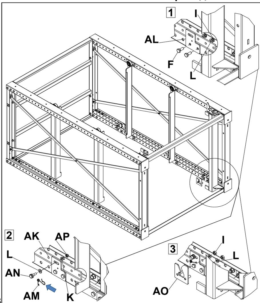
Установить держатели **AL** над правыми направляющими **верхней и нижней** платформ, отступив одно отверстие по перфорации стойки при помощи болтов **F**, шайб **L** и гаек **I**. Затем установить планку запирающую **AK** через **четвёртое отверстие снизу** при помощи болтов **AN** шайб **L**, **K**, гаек **AP**. Надеть пружину **AM** на болт **AN**. Установить упоры **AO** на планки запирающие при помощи шайб **L** и гаек **I** под держателями и далее с шагом крепления платформ.
