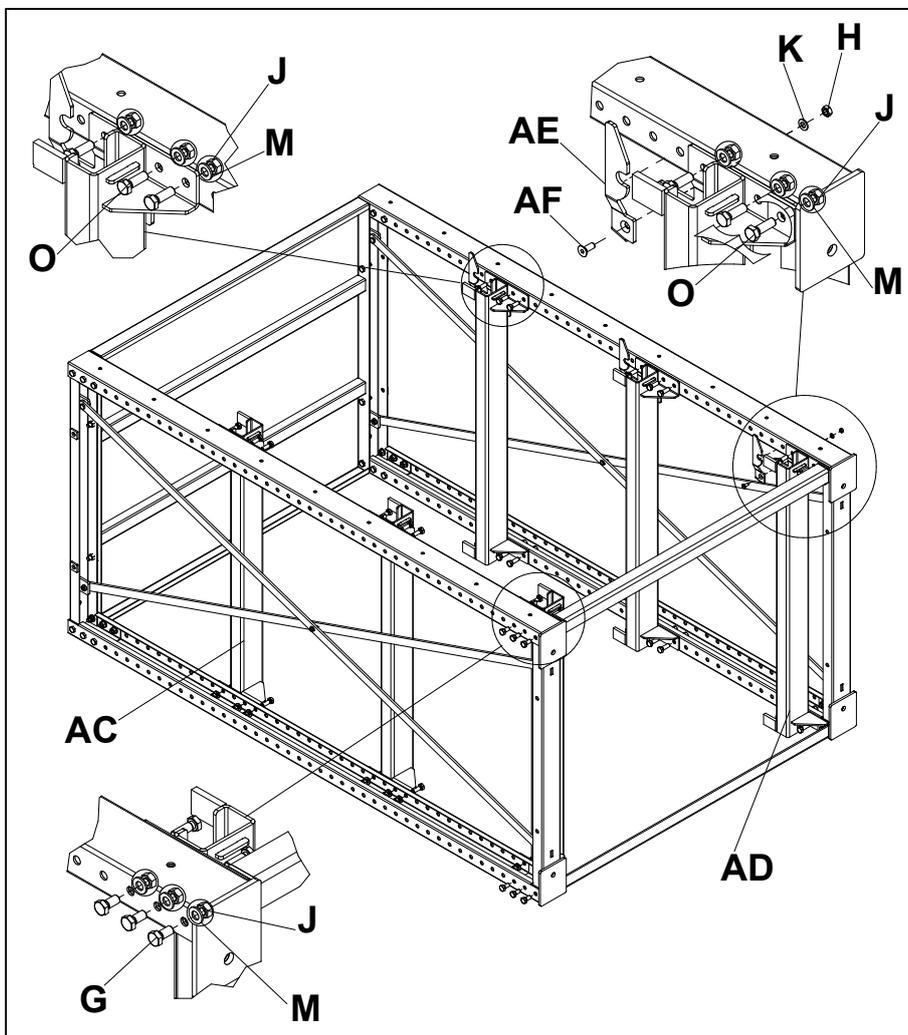
Наживить направляющие платформ полного выдвижения **AC**, **AD** на раму при помощи болтов **O** (M12x35), шайб **M** и гаек **J**, а также наживить соединители **N** при помощи болтов **O** (M12x35), шайб **K** и гаек **H**.
