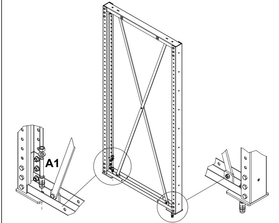
Закрепить к полу рамы стеллажа при помощи анкерных болтов **A1** (M16x150).
