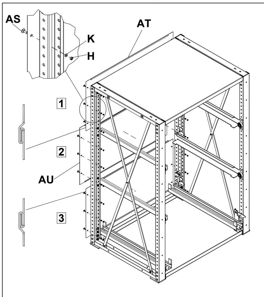
Последовательно установить стенки задние **AT, AU** начиная с верху стеллажа при помощи болтов **AS** (M8x25), шайб **K**, гаек **H**. Установить каждую последующую стенку в зацеп на предыдущей, а затем установить болтовые сединения.
