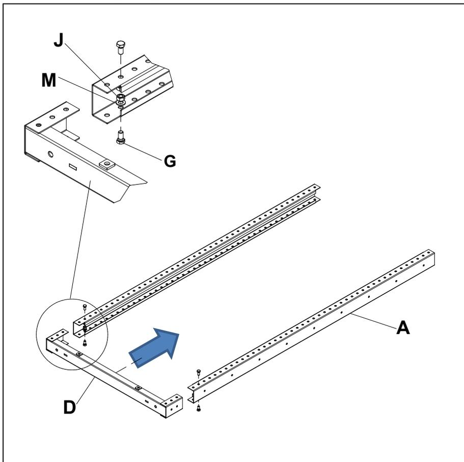
Наживить крышку **D** внутрь стоек **A** при помощи болтов **G** (M12x25), шайб **M** и гаек **J** через второе отверстие от края стойки.
