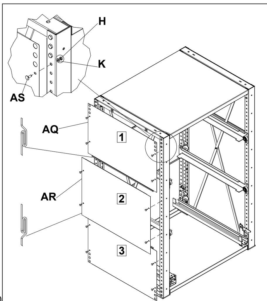
Последовательно установить стенки боковые **AQ, AR** начиная с верху стеллажа при помощи болтов **AS** (M8x25), шайб **K**, гаек **H**. Установить каждую последующую стенку в зацеп на предыдущей, а затем установить болтовые соединения.
