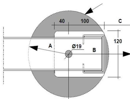
Зона воздействия на пол при бурении отверстия **A=112,5 мм**
