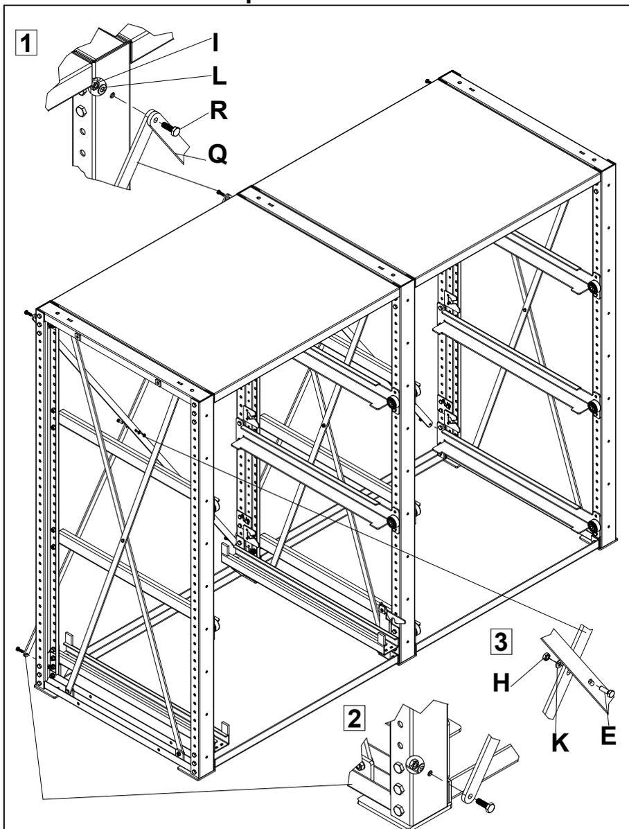
При установке нескольких секций в линию наживить два раскоса **Q** при помощи болтов **R** (M10x30), шайб **L** и гаек **I** на промежуточных стойках соседних секций сверху и снизу, затем наживить раскосы по диагонали на соседней раме.
